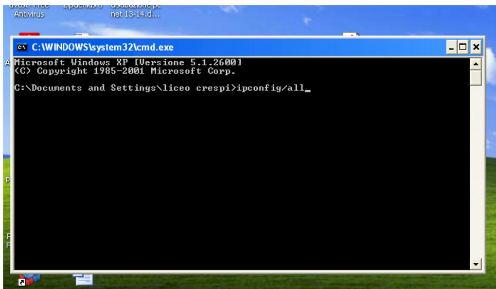
5) Premendo "invio" si visualizzerà una sequenza di dati relativi alle schede installate sul pc:
